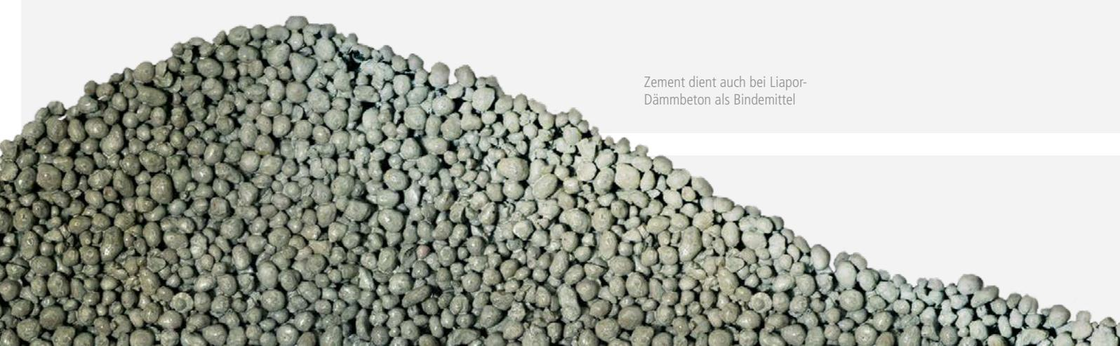
Zement dient auch bei Liapor-Dämmbeton als Bindemittel
